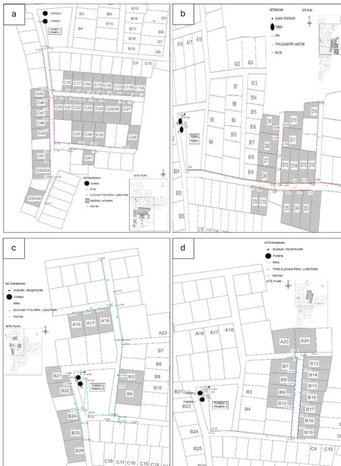
Gambar 3. (a) Elevasi perpipaan dari tandon 1 pompa 1, (b) elevasi perpipaan dari tandon 2 pompa 1, (c) elevasi perpipaan, (d) elevasi perpipaan dari tandon 2 pompa 3
