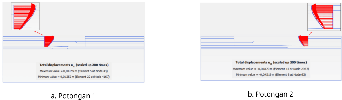
Gambar 11. Analisis deformasi lateral pada dinding secant pile
