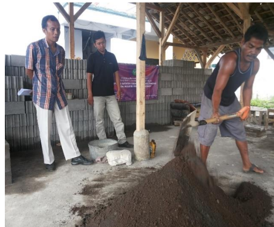
Gambar 4. Pencampuran bahan pasir dan abu batu dilakukan secara merata
