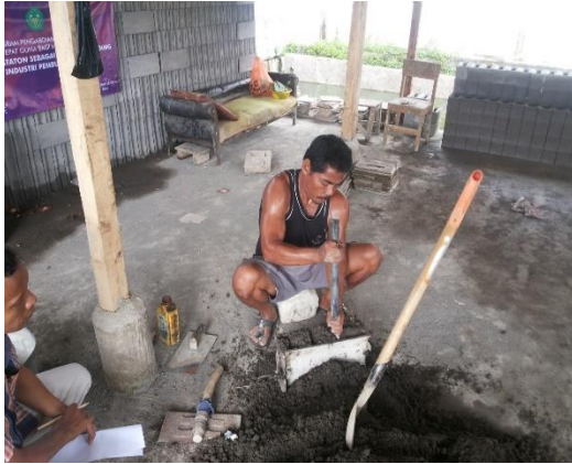
Gambar 7. Proses pencetakan bataton
