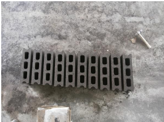
Gambar 8. Proses penyusunan bataton yang hasil proses pencetakan
